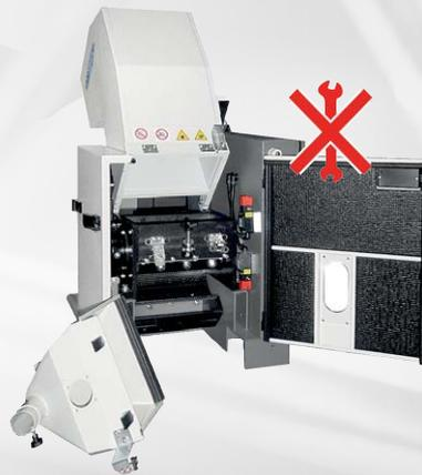
Bei Routine-Wartungsarbeiten sind die Hauptbauteile ohne Werkzeuge zugänglich. Auf Rollen verfahrbar.
