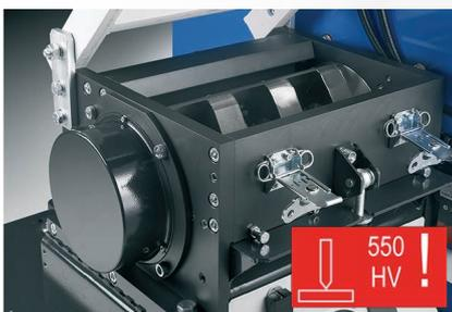
Mahlkammer in verschleißfester Ausführung 550HV. Lager, direkt an der Mahlkammer montiert.
