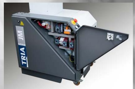
Integriertes Elektrobedienfeld. Sicherheits- einrichtungen und -schaltungen gemäß EU-Richtlinien.
