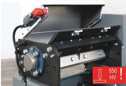
Mahlkammer in verschleißfester Ausführung 550HV
