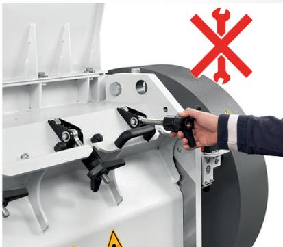
Bei Routine-Wartungsarbeiten sind die Hauptbauteile ohne Werkzeuge zugänglich.
