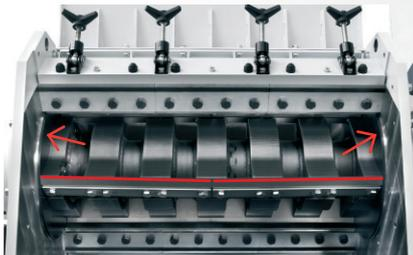
Mitlaufende Seitenscheiben. V-Rotor mit 3 oder 5 Messerreihen; Einstellung der Rotor-/Statormesser mit Einstelllehre.
