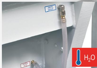
Wasserkühlung der Mahlkammer. Das Sieb entspricht ca. 50 % des Schneidkreis.
