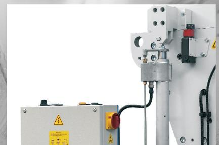
Öffnen des Zuführschachts erfolgt über motorgetriebene Hebevornrichtung. Öffnen des Siebhalters erfolgt über Gasdruckzylinder.
