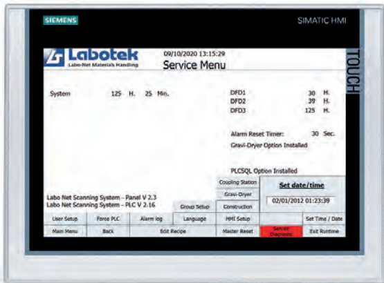
Großes Service Menü mit Zeiteinstellungen und Alarmspeicher
