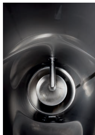
Saugstutzen mit Ablass und Absperrschieber.
