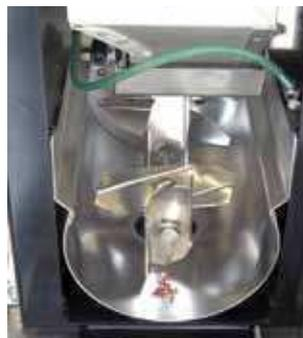
**Einfacher Zugang zu allen Granulatkontaktflächen.**
