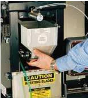
**Entnehmbarer Wiegetrichter ermöglicht einfachen Zugang zu der Mischkammer.**
