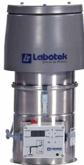
zur Verarbeitungsmaschine fördern. Um einen Mindestfüllstand im Mühlenrichter zu erreichen ist der Förderintervall zwischen den Förderzyklen einstellbar.
